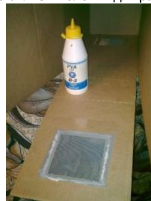
Так мы клеиваем сетку (можно обойтись хорошим скотчем).
